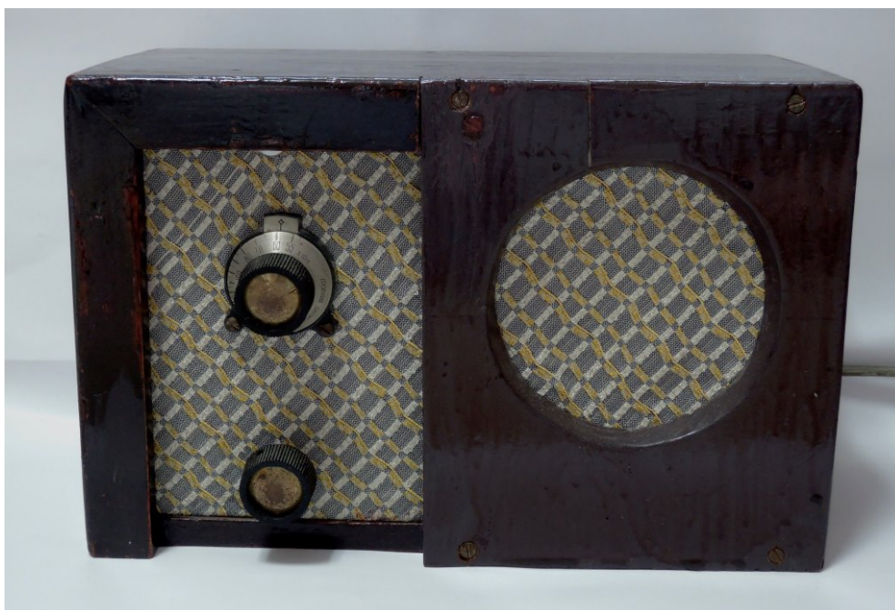
バリコンには最も小型の周波数直読目盛が付いた微動ダイヤルを設けた。横幅 28.5cm 下の摘まみはスイッチ付きボリュームである。
